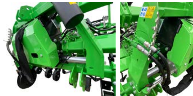
Sistema di guida integrato tramite telecamere Integrated side shifting system with cameras
